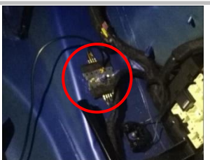
2.14 撑杆负极：用我司负极铜片插上，拧紧螺母
