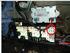
2.11 接正极方式一：在尾箱右侧如图位置找到原车保险丝正极
