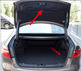
2.1 拆卸上门锁盖板，然后把线束如虚线穿到上门锁盖板；
