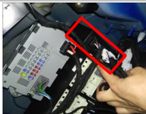
4.2 装 ECU:使用魔术贴安装 ECU,固定在此后备箱右侧,保险盒旁,防止松动脱落;
