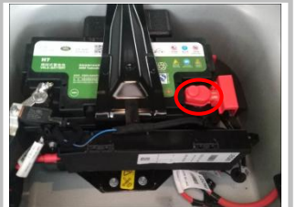
2.9 接正极方式一：掀开正极电瓶盖，用我司正极线接此原车电瓶正极
