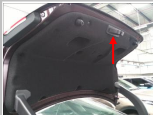
2.4 接门锁信号线，在上尾门找到原车信号线位置
