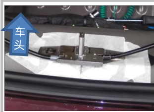
3.4 安装下门锁扣：把门锁装上，用2颗异型螺栓平行拧紧，注意把锁尽量上调，否则开门声音很大
