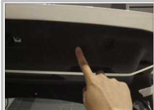
4.4 拆下此处原车塑料件,安装我司开关
