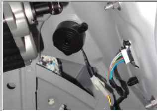
4.3 安装蜂鸣器:与 ECU 接头对接,并把蜂鸣器装在右侧装饰板内空旷处
