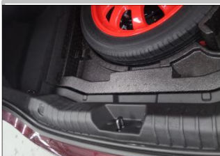
3.1 把后踏盖的3颗固定螺丝拆下，然后拆下后踏盖（注意：后踏盖还有4个卡扣，注意拆卸力度，避免卡扣断裂）
