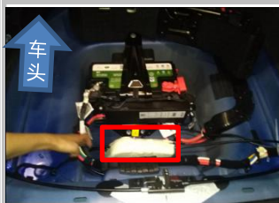
3.8 把包装好的驱动盒安装在如图备胎下方空位,需固定好,防止行车时松动
