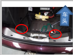
3.9 用扎带把圆圈位置的左右两边拉线固定好,防止拉线与盖板、钣金摩擦
