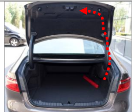
2.3 把 2 扎布线束（接开关、接门锁信号）延伸到尾箱上门锁扣处，延伸线用胶布或扎带固定好；（虚线） “线束尽量预留足够长度”
